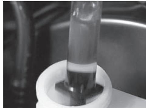
para aspirar hacia fuera el líquido contaminado del contenedor del cilindro maestro.
