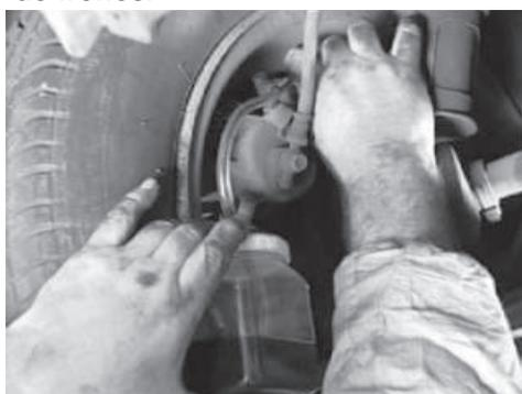
Repetir este procedimiento por cada una de las otras estaciones de frenos, moviéndose mas cerca hacia el cilindro maestro.
