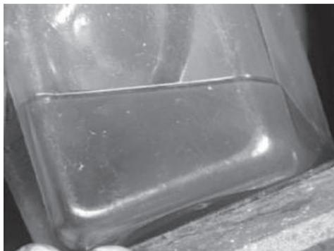
Continuar con este proceso hasta que no haya mas burbujas de aire viniendo de la estación de freno y hasta que se vea el nuevo líquido de frenos.
