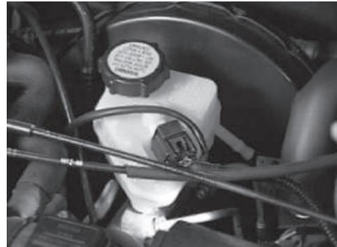
Llevar adelante un control final por cualquier tipo de pérdidas alrededor del cilindro maestro o estaciones de frenos.
