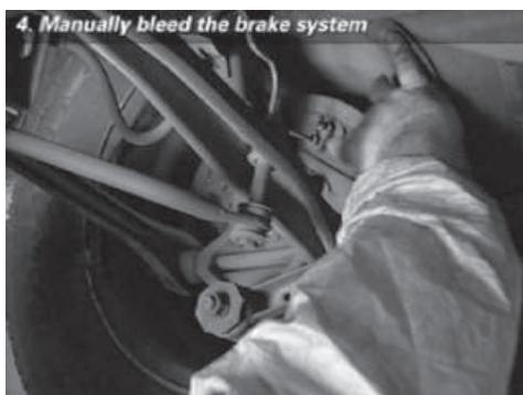
Abir o aflojar el tornillo de purgado que se encuentra mas allá del cilindro maestro y solicitar por la asistencia de un ayudante para que empuje el pedal del freno.
