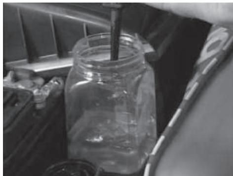
Colocar el líquido de frenos absorbido dentro de un contenedor que pueda ser desechado en una manera que no contamine el medio ambiente.
