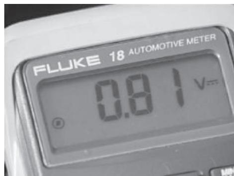
Si el voltaje es más alto, esto indica que hay una reacción galvanizada, y significa que hay un nivel no aceptable de humedad en el líquido de frenos.
