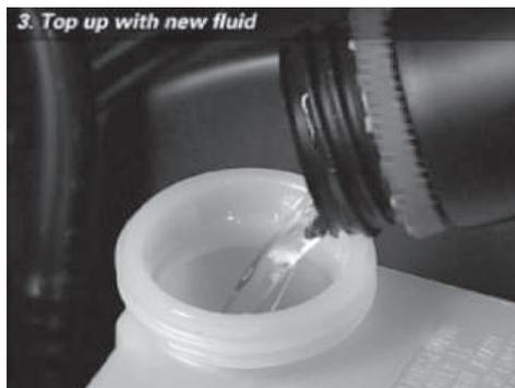
Llenar el contenedor del cilindro maestro con líquido de frenos
