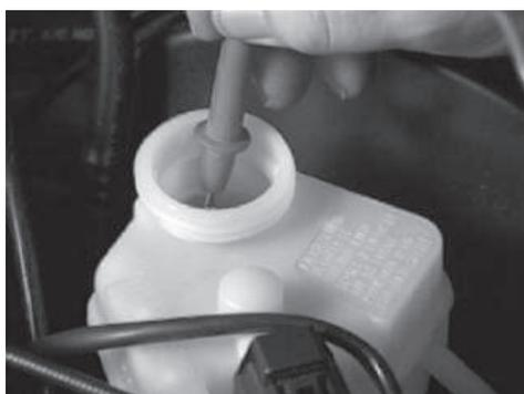
Colocar una de las probetas del multímetro digital de voltios y ohmios dentro del líquido de frenos,
